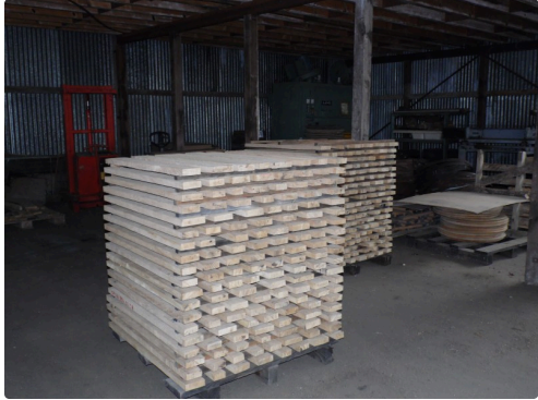
Les merrains terminés dans la méranderie
