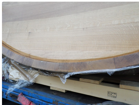
Des merrains de chêne sessile de 10 cms d'épaisseur
