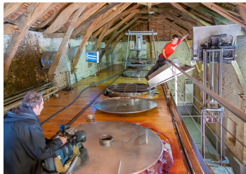
Remplissage des cuves par gravité ; le raisin est monté par un transpalette
