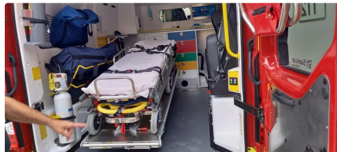
Le VSAV équipé d'un brancard hydraulique
