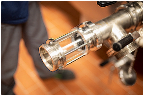
Conduite avec partie en verre pour contrôler le moût
