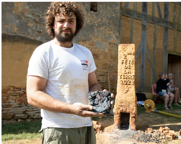
Fer brut de fonderie, qui va être martelé pour former un lingot
