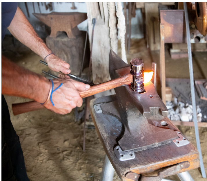
La pièce est martelée
